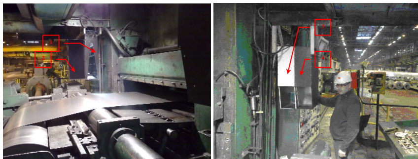
Рис. 3 Выходная сторона дрессировочного стана с осветителем (1) и экраном тепловизора (2) со стороны привода, а также боксы телевизионной (3) и тепловизионной (4) камер электронно-оптической системы измерения плоскостности и температуры полосы со стороны обслуживания
