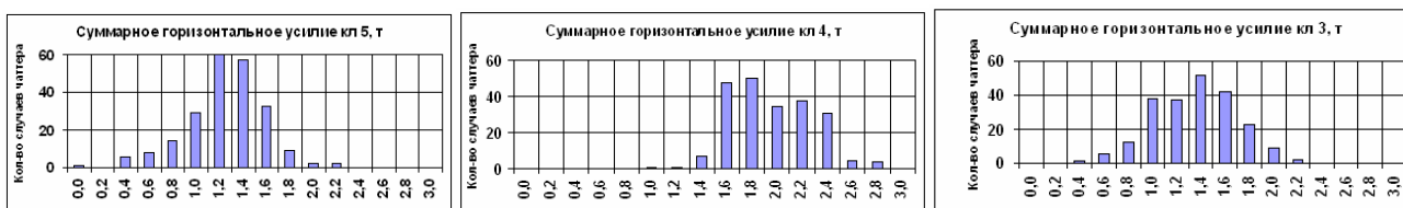
Рис. 3 – Распределение суммарного горизонтального усилия на подушки рабочих валков
