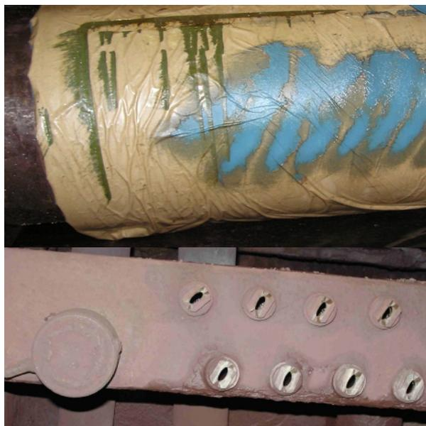
Рис.1. Следы факела форсунок на нижнем валке со стороны выхода и зеркальное отображение расположения форсунок на коллекторе
