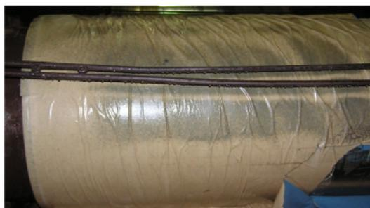
Рис.2. Следы факела форсунок на верхнем валке со стороны входа
