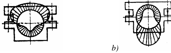
Fig. 10 – Work rolls shocks deformation under the maximum bending forces: a) «Positive» (up) 900 kN force; b) «negative» (down) 450 kN force
